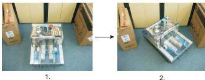
Obr. 9 Zjednodušený priestor pre porovnávanie dvoch máp, 1. poloha vozidla v počiatku súradnicovej sústavy, 2. poloha vozidla po zavedení chyby polohy
